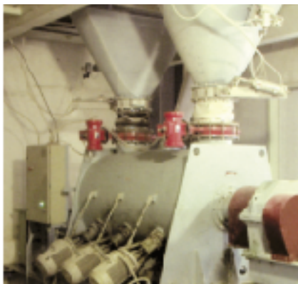
рис. 3. Дисковые поворотные затворы ГРАНВЭЛ®, установленные на технологической линии по производству сухих строительных смесей
