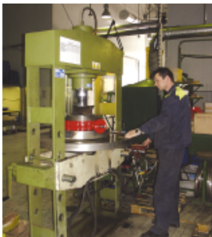
рис. 2. Тестирование затворов на производственном комплексе Компании АДЛ в пос. Радужный (Коломенский р-н, Мос. обл.)
